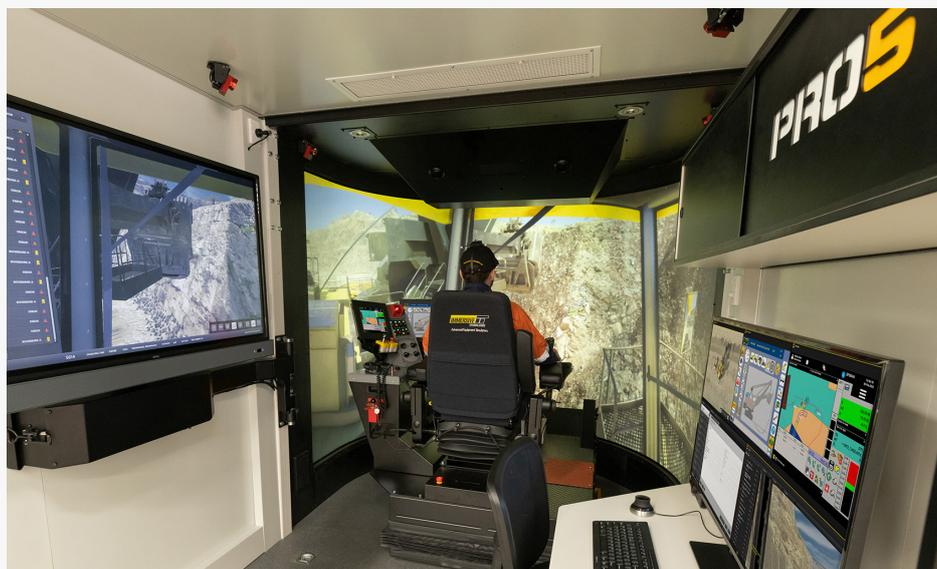
*PRO5 - Simulador de Equipos Avanzados con pantalla estereoscópica 3D y sistema visual profesional*
